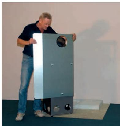
Monter la tôle de protection thermique
