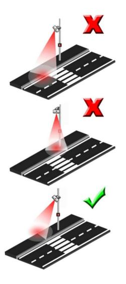
Le cône de détection doit être positionné à côté des passages pour piétons sans dépasser la chaussée.
